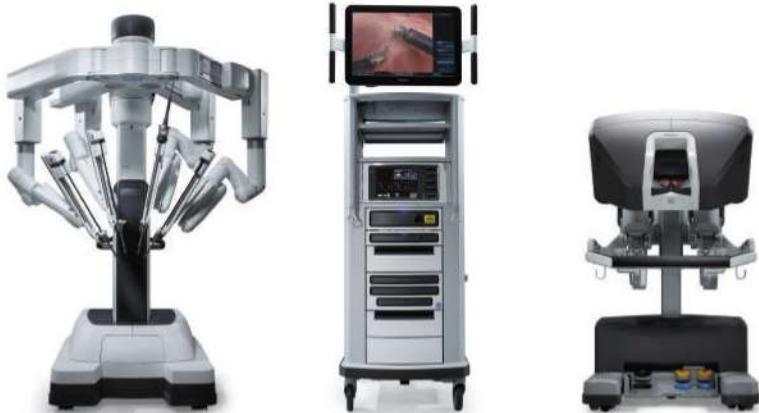
「ダヴィンチ」のシステムは、ロボット本体と操作台、助手用のモニターなどで構成され、ロボット本体には3本のアーム（手術操作を行うロボットの腕）と1本のカメラ（術者の目となり手術部位を映し出します）が装着されます。術者はケーブルでつながった操作台に座り、中に映し出される立体（3次元）画像を見ながらアームを操り、手術操作を行います。
