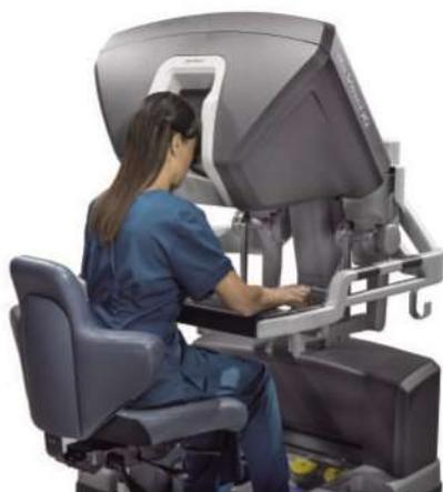
基本的には、現在も既に行われている腹腔鏡手術に準ずる手術ですが、ダヴィンチ手術が、従来より優れている点として、手術部位の内視鏡画像が、高精度の3次元画像で見えること(物の奥行きを感じることが出来る)、3本のアームを術者が自由に操作することが可能で、人間の手以上の可動域のある色々な鉗子(手術を行うハサミや電気メスなどの手術用器具)を使用することにより、かつては不可能であった精密で細かい操作が可能であること、人間の手先の震えを補正し、高い集中力を必要とする細かな作業でも、正確に操作することが可能であることなどが挙げられます。
